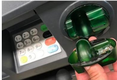
Рисунок 1 – Скиммер – накладка на картоприемник
