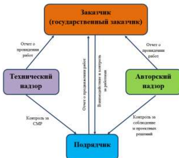
Рисунок 1 – Схема взаимоотношений между заказчиком, подрядчиком, техническим и авторским надзорами
