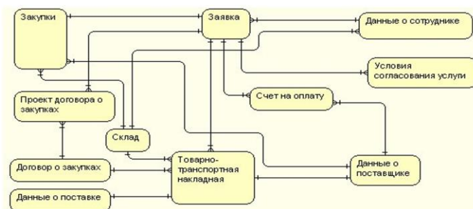
Рисунок 4 – Концептуальная модель БД по задаче автоматизации управления поставками КИ на головном ВТПАО с учетом требований по ИБ
